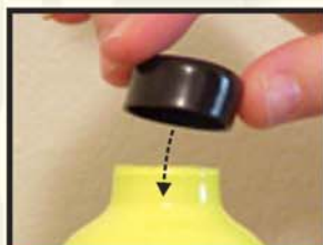
Nasaďte krytku pro zabránění znečištění vnitřní strany hliníkové lahvičky.
